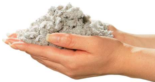
セルロースファイバーは新聞紙をリサイクルした木質由来の断熱材
